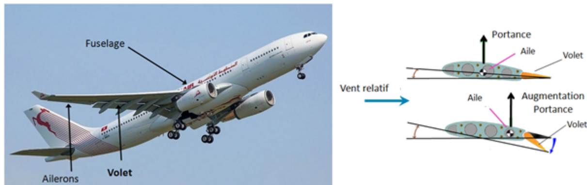
FIGURE 2 – Dispositif de volets dans un avion
