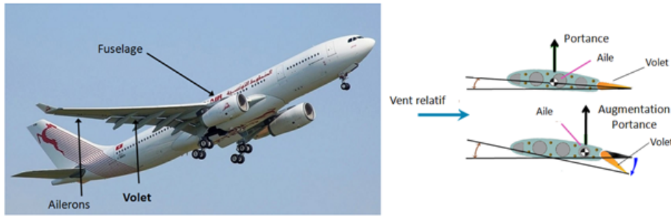
FIGURE 1 – Dispositif de volets dans un avion
